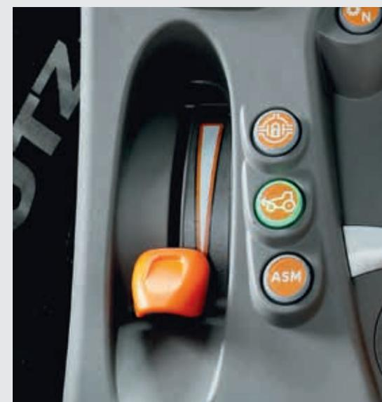
Acceleratore a mano indipendente e attivazione elettroidraulica del bloccaggio del differenziale, trazione integrale e funzione di automazione ASM.
