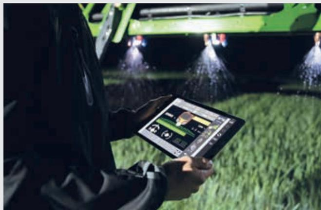
↑ Funzione XTEND con tablet, comando delle attrezzature tramite ISOBUS UT dall'esterno della cabina.
