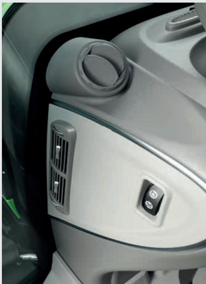
↑ Bocchette di ventilazione aggiuntive e interruttore principale della batteria comodamente accessibile in cabina.
