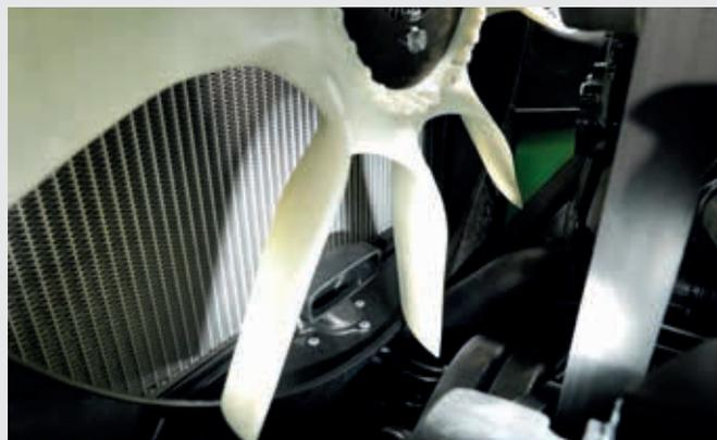
↑ Ventola viscostatica elettronica (eVisco) con tubo di aspirazione per sistema di pulizia preliminare filtro aria.
