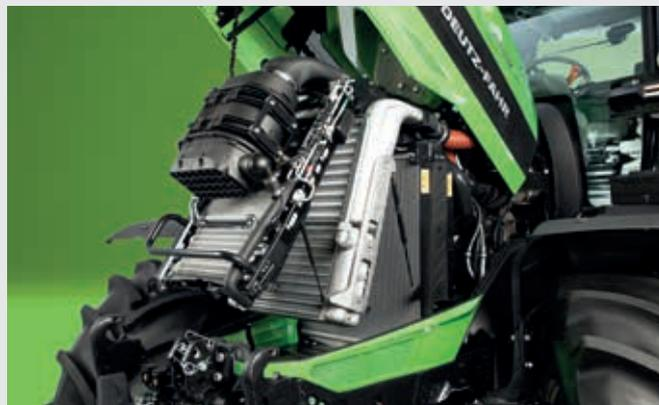
↑ Impianto di raffreddamento in alluminio con leva di accesso azionabile con una mano e filtro aria Powercore.
