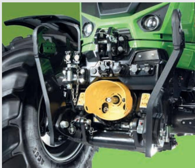
↑ Sollevatore anteriore con capacità di sollevamento di 5.450 kg e presa di forza anteriore DualSpeed.
