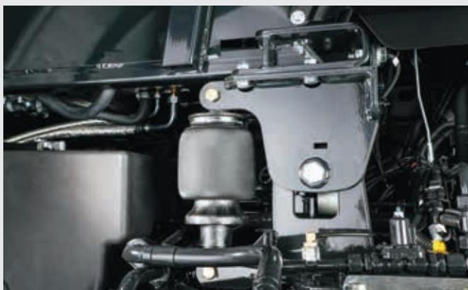
↑ Cabina con sospensione pneumatica per il massimo comfort di guida.
