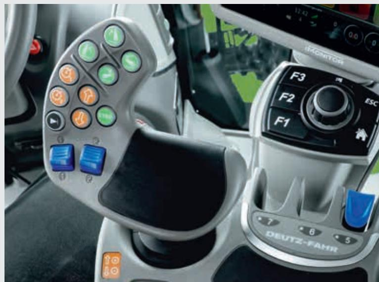
↑ Ergonomico joystick MaxCom con unità di comando per sollevatori anteriore e posteriore, motore, trasmissione, svolte alla capezzagna e due distributori idraulici proporzionali.
