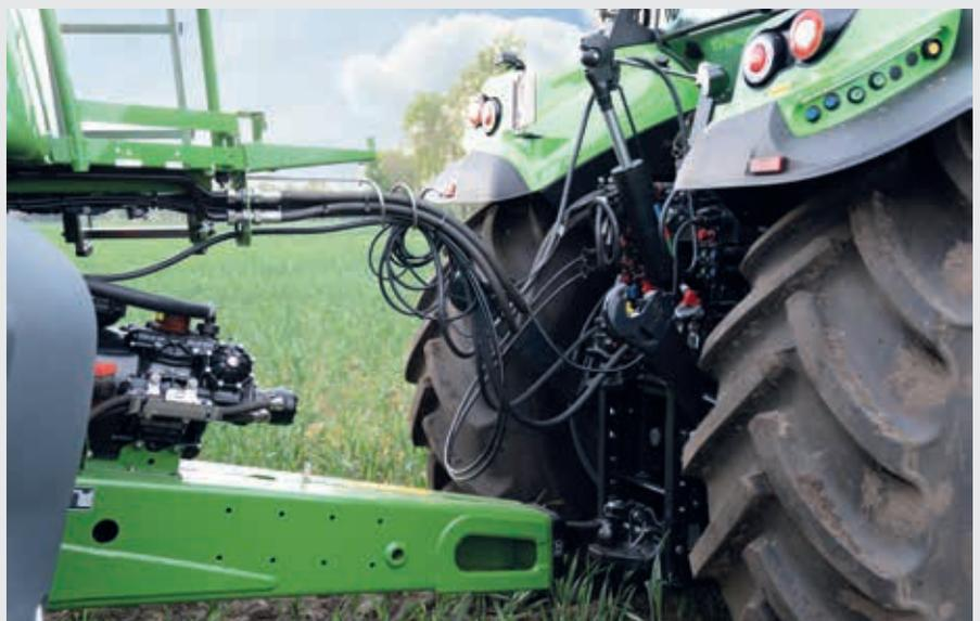
↑ Sollevatore posteriore in posizione di trasporto per una minore interferenza con i bracci in fase di sterzata.
