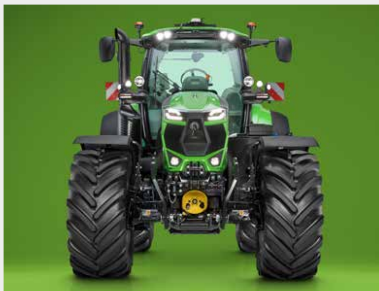
La presa di forza anteriore DualSpeed offre un alberino scanalato amovibile, che consente il collegamento del trattore agli attrezzi con alberi di trasmissione di qualsiasi tipo.
