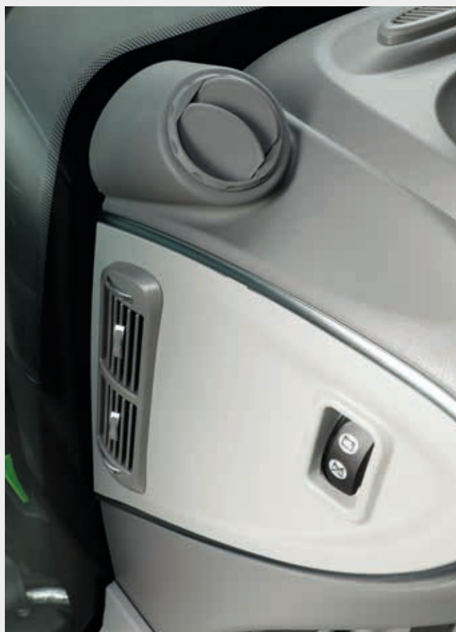
↑ Nuove bocchette di ventilazione regolabili e lo staccabatteria in posizione comoda sul lato sinistro del piantone dello sterzo.
