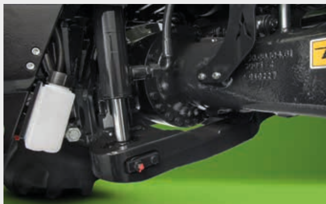
↑ Assale anteriore del 6190 TTV con robusto braccio oscillante inferiore.
