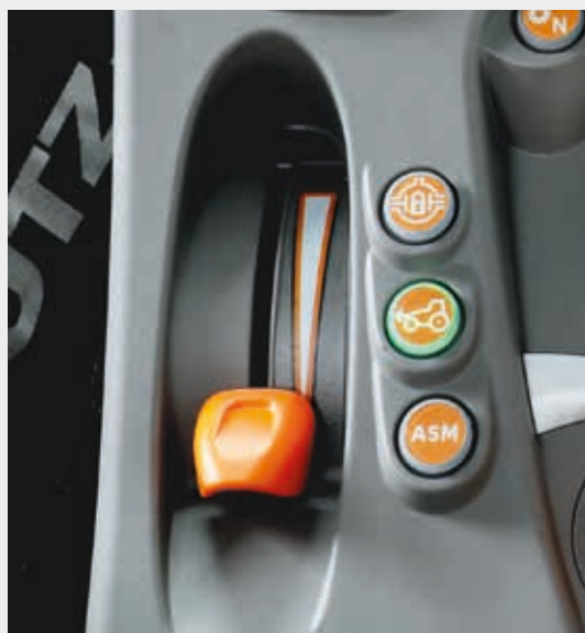
↑ Acceleratore a mano indipendente e attivazione elettroidraulica del bloccaggio del differenziale, trazione integrale e funzione ASM.
