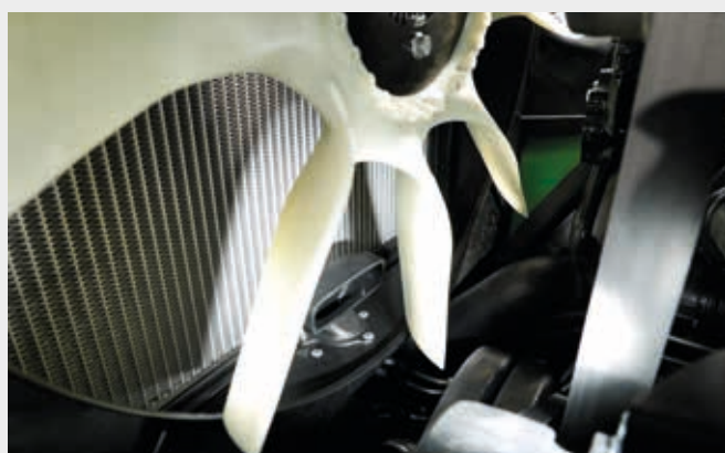
⬆ Ventola viscostatica elettronica (eVisco) con flessibile di aspirazione per sistema di pulizia preliminare filtro aria (elimina il 95% delle particelle grossolane prima che possano raggiungere i filtri).
