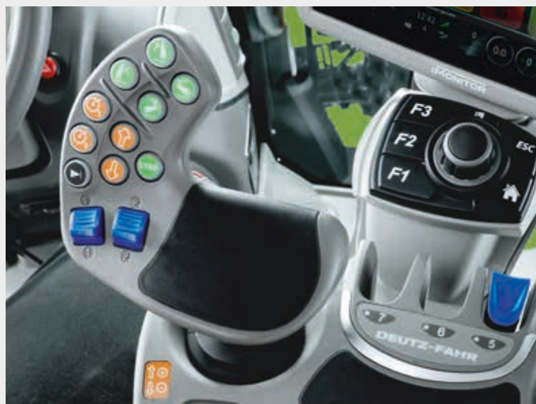
⬆ Ergonomic joystick MaxCom con pulsanti di sollevamento, comando motore e trasmissione, pulsante per la gestione delle svolte in capezzagna e due distributori idraulici proporzionali.
