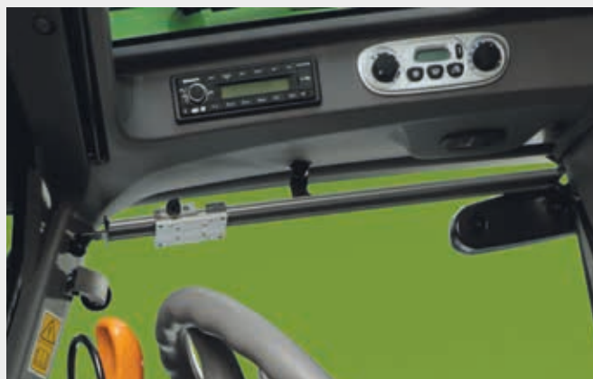
↑ Interfacce di comando radio, climatizzatore e luci, oltre al supporto scorrevole per il monitor.
