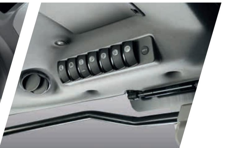
> Il sistema di filtrazione cat. 4, azionabile con un semplice pulsante, assicura la protezione da sostanze aerosol pesticidi.
