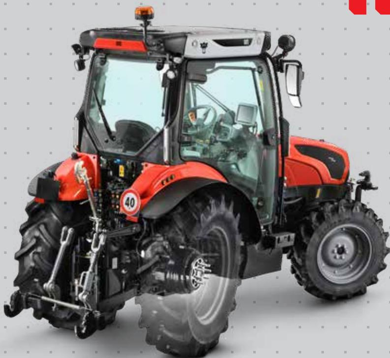
personalizzata dall'operatore scegliendo tra due modalità di funzionamento dell'asse posteriore rispetto a quello anteriore. Entrambe le modalità permettono di ridurre drasticamente i tempi e gli spazi necessari per effettuare le manovre e, per questo motivo, si rivelano particolarmente utili negli spazi stretti e per le manovre a fine filare.
