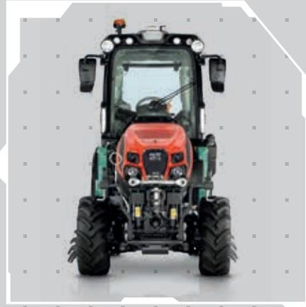
Il gran numero di connessioni idrauliche (fino a 21) consente l'installazione di svariate combinazioni di attrezzi (anteriori, ventrali e posteriori). Il Frutteto CVT S può essere dotato di un serbatoio carburante modellato consentendo l'installazione di attrezzi ventrali e mantenendo una larghezza complessiva del trattore inferiore a 1,3 m.
