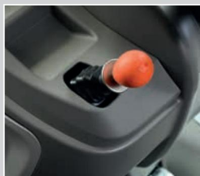
Tutti i SAME Frutteto CVT sono dotati di sistema di frenatura integrale sulle 4 ruote e del freno di stazionamento idraulico (HPB).
